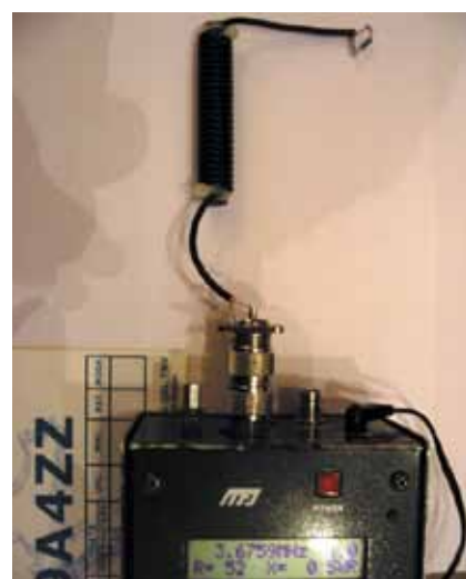
Slika 3. Guanella strujni BALUN 1:1(50:50), UNUN 1:1(50:50)
