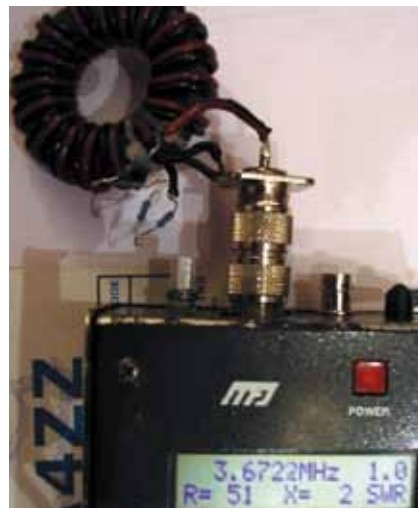
Slika 1a. TLT Ruthroff BALUN 1:4 (50:200 Ω)
