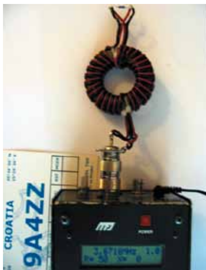
Slika 2a. TLT Guanella BALUN 1:1 (50:50 \Omega )
